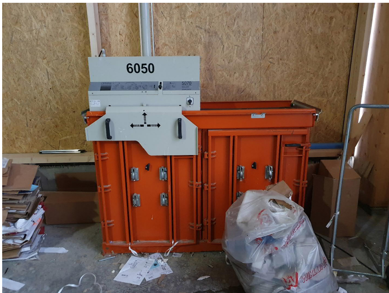
Bild 1 Komprimator/balpress på byggarbetsplatsen Magasin X
